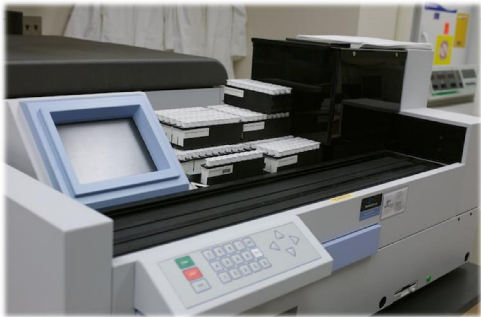
圖：井型式的閃爍計數儀「自動加馬計數儀」系統
